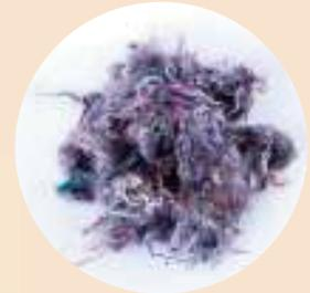
Fibre de textile recyclé obtenue à la fin du procédé de défibrage
