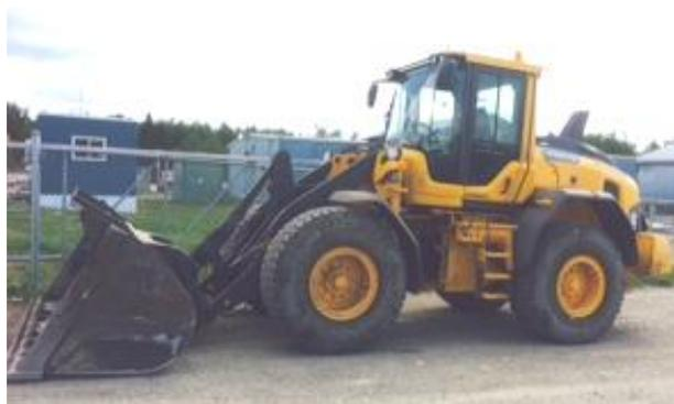
Le retournement se fait à l'aide d'un chargeur sur roue ou d'une excavatrice sur chenilles munie d'un grappin hydraulique (pelle mécanique).
