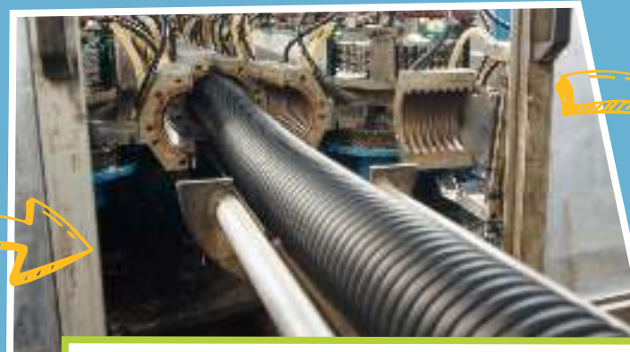
7 SERVENT DANS LA FABRICATION DE CONDUITES DESTINÉES À LA MAÎTRISE DES EAUX PLUVIALES.
